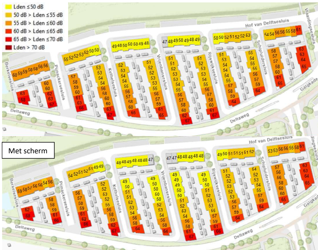
Figuur 5.18: De geluidbelastingen met betrekking tot wegverkeer in de buurt van de Deltaweg voor de situatie zonder (boven) en met scherm (onder) van 2 m hoog inclusief gebouwen ter plaatse van de ontwikkelvelden. (bron onderlegger ESRI)
