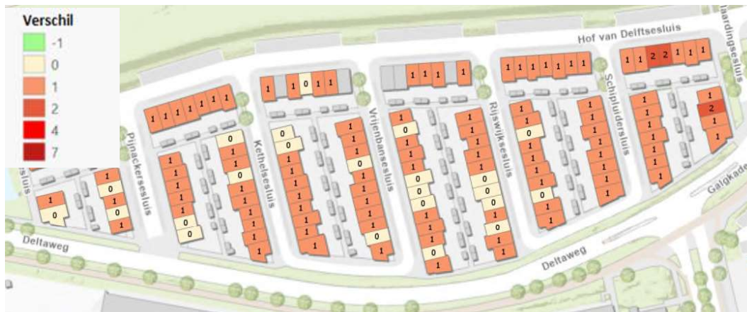
Figuur 4.9: Verschillen in de buurt van de Deltaweg ten gevolge van wegverkeer (inclusief verkeersvariant 1) voor de situatie met gebouwen ter plaatse van de ontwikkelvelden. In dit figuur zijn alleen de woningen met een geluidbelasting van boven de 50 dB excl. aftrek ex artikel 110g Wet geluidhinder weergegeven. (bron onderlegger ESRI)
