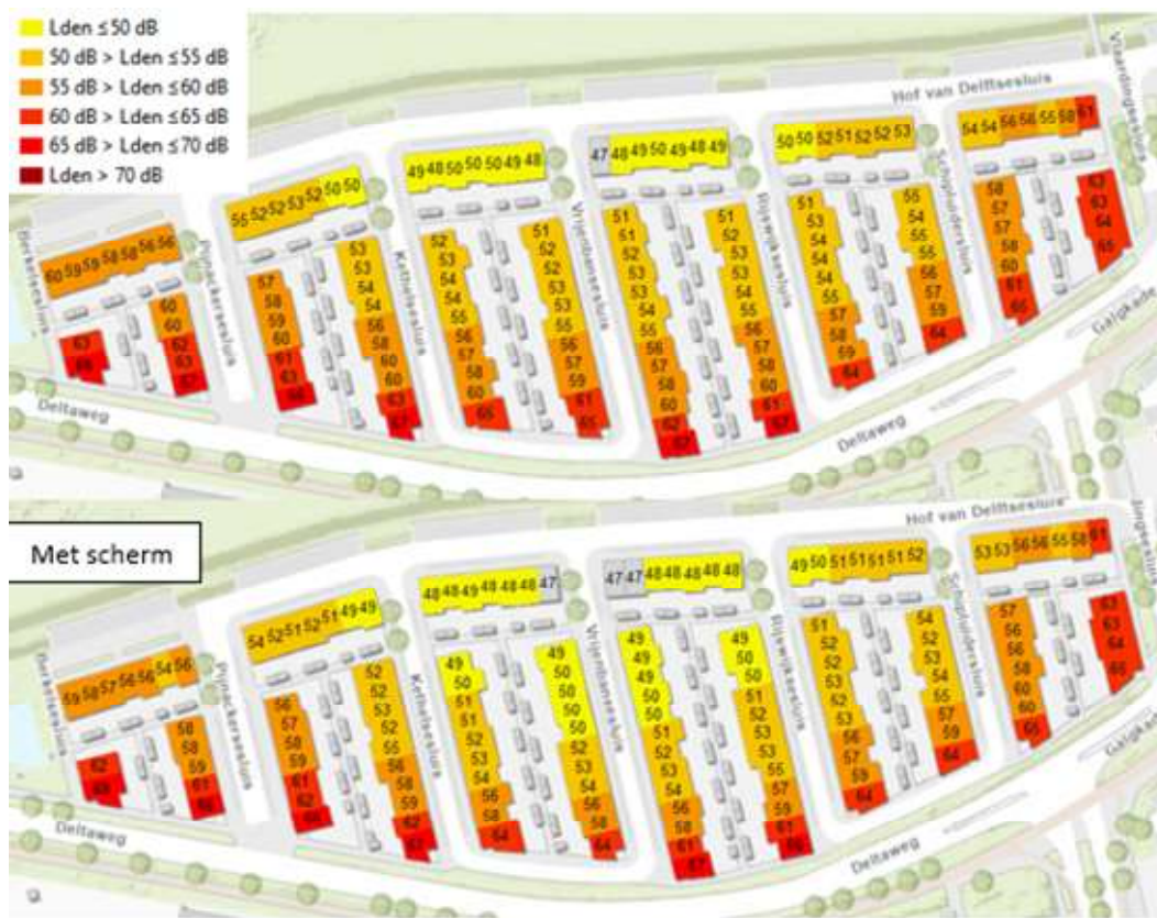
Figuur 6.19 Effecten van een 2 meter hoog geluidscherm aan de noordkant van de Deltaweg op de geluidbelasting door wegverkeer
