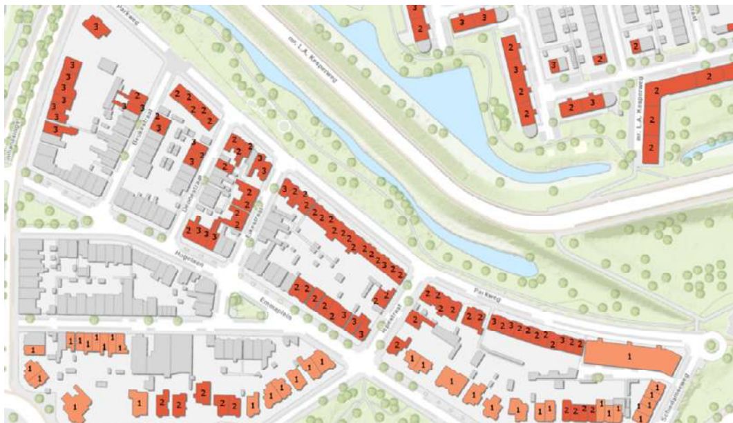
Figuur 4.15: Verschillen in de buurt van de Meester L.A. Kesperweg ten gevolge van wegverkeer (inclusief verkeersvariant 2) voor de situatie met gebouwen ter plaatse van de ontwikkelvelden. In dit figuur zijn alleen de woningen met een geluidbelasting van boven de 50 dB excl. aftrek ex artikel 110g Wet geluidhinder weergegeven. (bron onderlegger ESRI)
