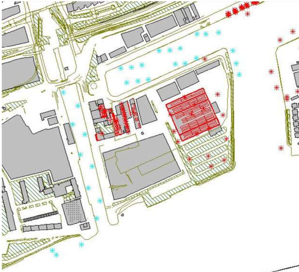
Figuur 5.19: Ligplaatsen waar walstroom kan worden toegepast ter beperking van geluidbelasting door nestgeluid.
