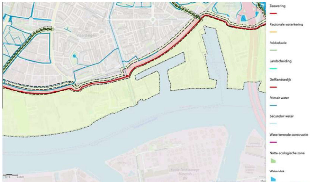
Figuur 5.37 Beschermingszone van het dijklichaam
