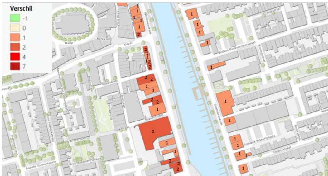
Figuur 4.8: Verschillen ter plaatse van de Westhavenkade en Oosthavenkade ten gevolge van wegverkeer (inclusief verkeersvariant 1) voor de situatie met gebouwen ter plaatse van de ontwikkelvelden. In dit figuur zijn alleen de woningen met een geluidbelasting van boven de 50 dB excl. aftrek ex artikel 110g Wet geluidhinder weergegeven. (bron onderlegger ESRI)
