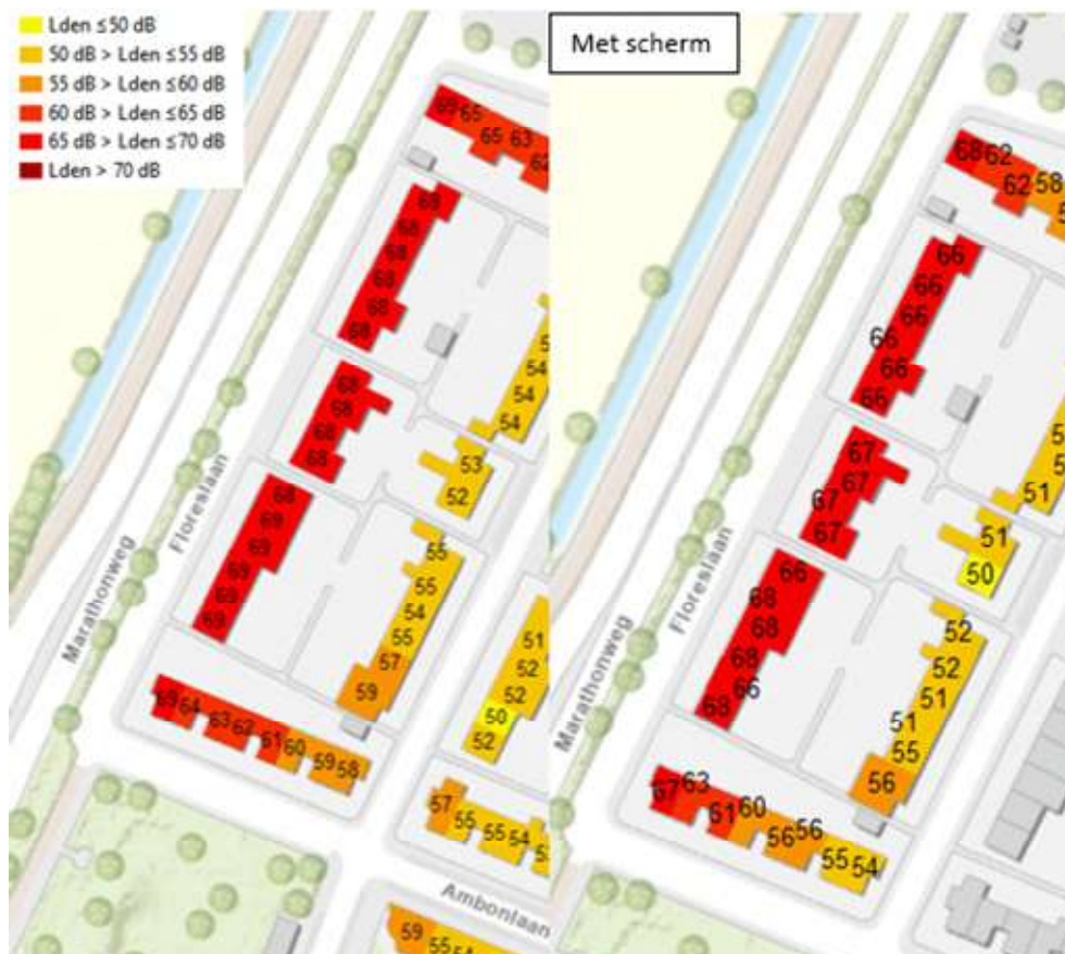
Figuur 6.20 Resultaten voor de geluidbelasting door wegverkeer van een 2 meter hoog geluidscherm tussen de Marathonweg en de Floreslaan
