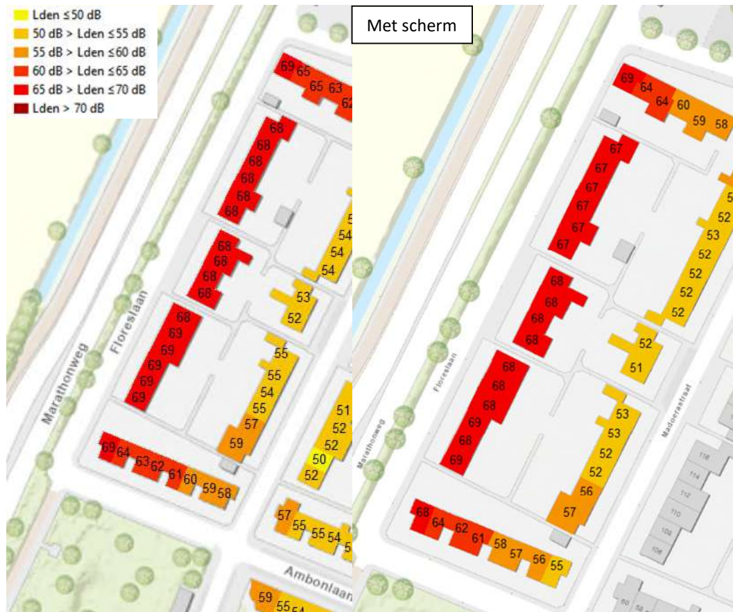
Figuur 5.15: De geluidbelastingen met betrekking tot wegverkeer in de buurt van de Marathonweg voor de situatie zonder (links) en met scherm (rechts) van 1.5 m hoog inclusief gebouwen ter plaatse van de ontwikkelvelden. (bron onderlegger ESRI)
